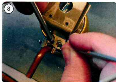
Legen Sie die Befestigungsplatte unter den Schmelztiegel und achten Sie darauf, das Temperaturkabel nicht zu beschädigen.
