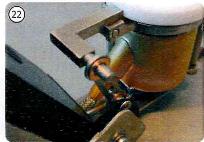
Montieren Sie die Schubstange auf der Klappe.
