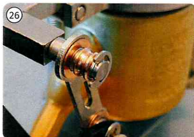
Setzen Sie den Clip auf die Klappe neben die Buchse.
