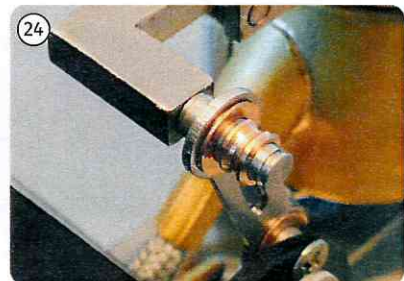
Montieren Sie die Buchse an der Klappe neben der Schubstange.
