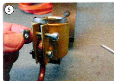
5 Lösen Sie die Schrauben, die das Heizelement halten.
