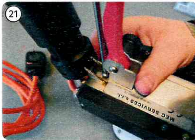
Befestigen Sie den Antrieb mit den Befestigungsschrauben am Gerät.
