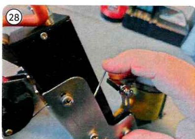
Ziehen Sie die Feder mit dem Finger in Richtung der Buchse an der Klappe zurück.
