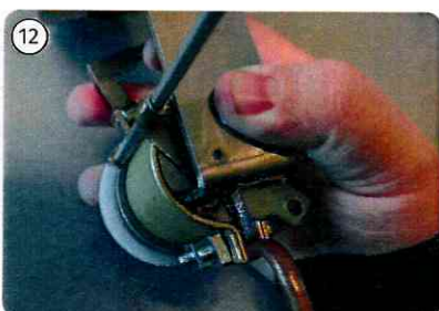
Befestigen Sie die Vierkantschraube lose wie hier abgebildet.
