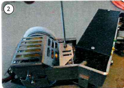
2 Lösen Sie die Schraube an der Seite des Hitzeschutzes.
